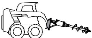
При маневрировании на рабочем участке рама размещается так, чтобы гидробур опирался на упор(поддержку) рамы, а рычаги погрузчика не закрывали обзор.
