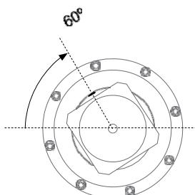
2. Поверните привод, чтобы наливное отверстие находилось под углом 60° – 70° от горизонтали
