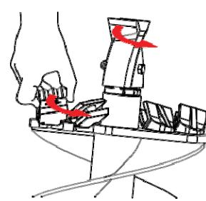
1. Установите шнек таким образом, чтобы получить доступ к нижней части
