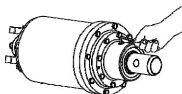
1. Положите привод на ровную поверхность заливным отверстием вверх. При помощи 8мм шестигранного ключа снимите пробку. Чтобы слить масло, поверните привод
